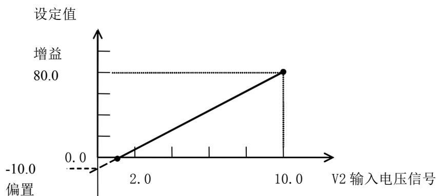
模拟输入设定偏置, 是指最小模拟量 (0V) 输入对应的设定值的百分比 (03-18)。
